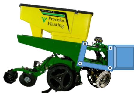
Chassi alinhado incorretamente
