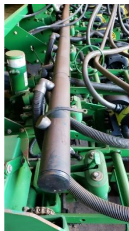
Tubulação condutora do vácuo
